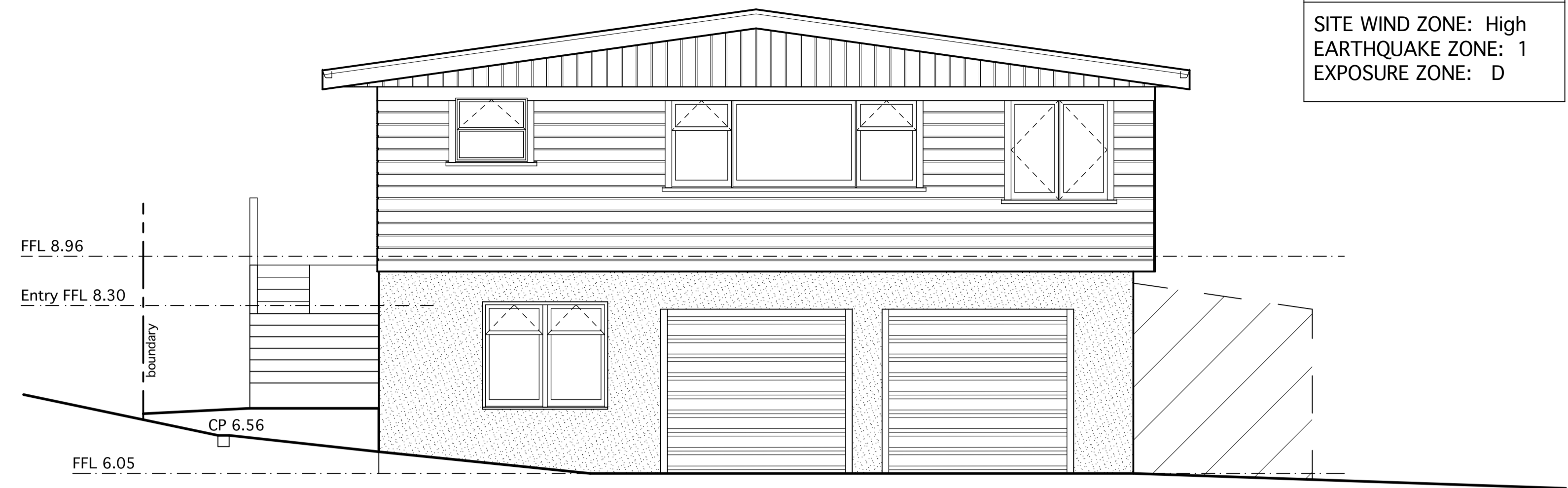
EXISTING EAST ELEVATION SCALE: 1:50 @ A1
